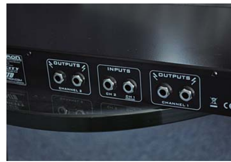
写真4 Velocity 100 LTDの背面端子。2チャンネルの出力が可能
