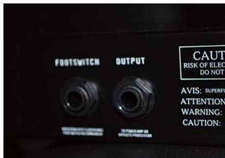
写真2 Widowmakerの背面にはフットスイッチ端子を搭載
