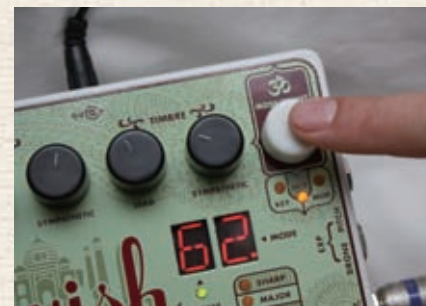
↑白いつまみを押すことでモードの切り替えが可能。回せばプリセット、押せばモード……という切り替えコントローラーだ
