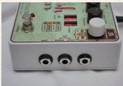
↑通常のインプット/アウトプットの他、エクスペッション・ペダルを接続できる端子が2つ用意されている
