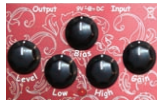
▲中央のつまみが、“真空管のニュアンスを変える”的な効果を生むバイアスだ
