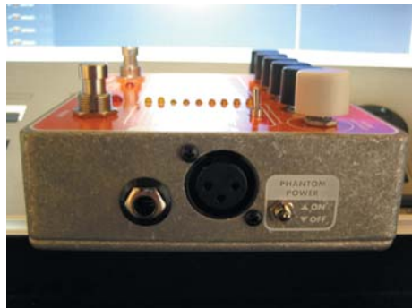
写真1 ファンタム電源に対応したXLRマイクとフォン形状のインストゥルメント入力を備える
