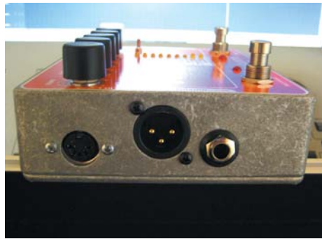
写真2 XLRアウトとインストゥルメント・アウト、MIDI IN端子
