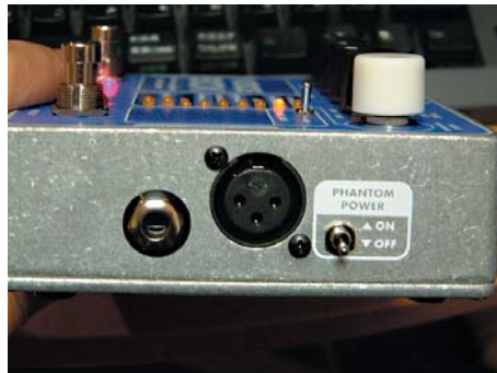
写真1 中央XLRインにマイク、左1/4フォーン・インにシンセサイザーやギターなどの楽器を接続。右はファンタム電源のON/OFFスイッチである
